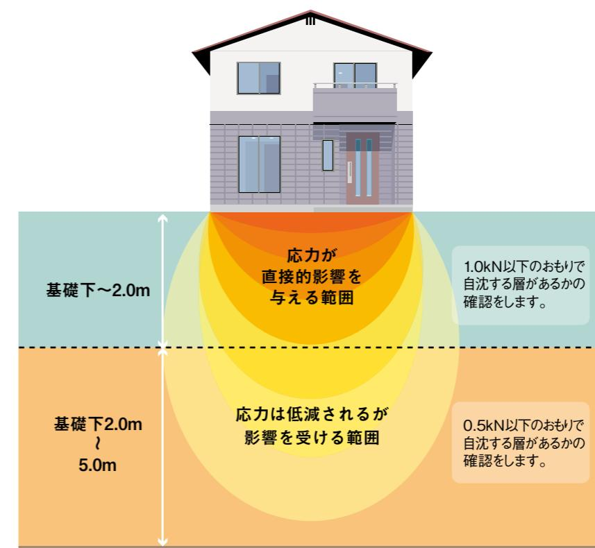
建物の重さは、真下だけではなく、上図のように拡散して地盤に伝わります。一般的な2階建て木造住宅では、基礎底面からおよそ2mで建物荷重はほとんど分散されるとされています。そこで沈下の検討では、基礎下2mまでと基礎下2m～5mを分けて調べます。
