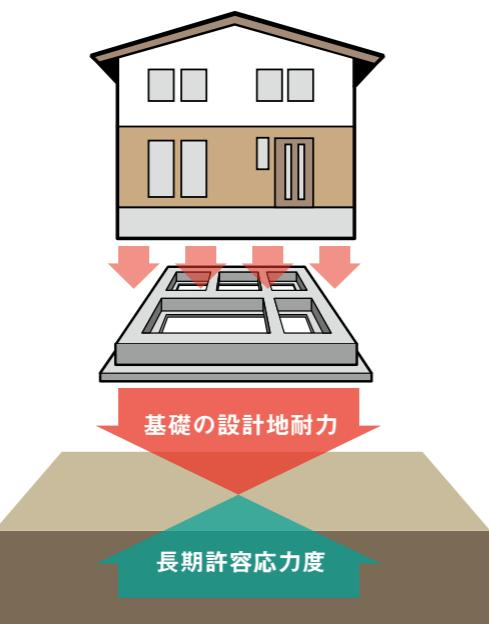
「地盤の長期許容応力度」とは主に地盤の破壊に対する強さを表し、支持力ともいいます。地盤は、その支持力より大きな力がかかると、せん断破壊を起こします。実際は通常木造住宅のような軽い建築物で、せん断破壊に至るケースはほとんどありませんが、一度破壊するとその強度が著しく低下するため、必ず地盤の長期許容応力度  $\geq$  基礎の設計地耐力 としなくてはなりません。
